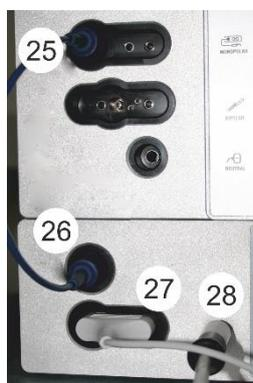
Conecte la salida monopolar (25) del dispositivo HF a la entrada del módulo de argón (26).
