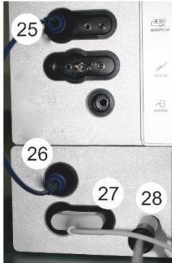
Connectez la sortie monopolaire (25) de l'unité HF à l'entrée du module argon (26).
