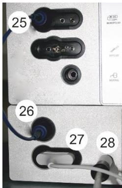
Den monopolaren Ausgang (25) des HF-Apparats an den Eingang des Argonmoduls (26) anschließen.
