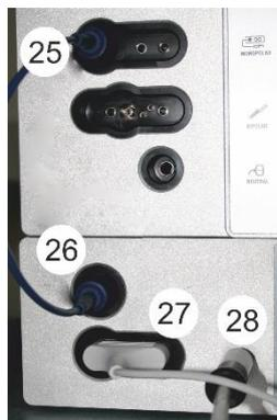
Collegare l'uscita monopolare (25) del dispositivo HF all'ingresso del modulo argon (26).
