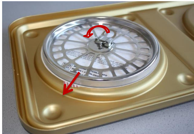
Figure 2 : porte-filtre avec un papier filtre
