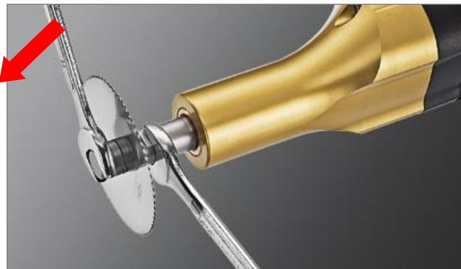
ilustración 3 Soltado del tornillo de sujeción
